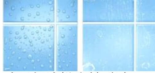
شكل (٣٢) في البلاطات التقليدية، يشكل الماء قطرات والتي تجف وتترك وراءها ترسبات وأوساخ
